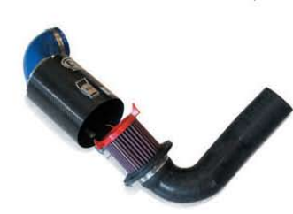
После каждого заезда нужно проверять, не «наелся» ли снега воздушный фильтр. С быстроремнем тюнинговым «нулевиком» делать это проще
