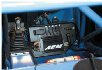
На трек от сырости часто возникают проблемы с электрикой. Поэтому многие команды полностью переделывают проводку, перенося важные блоки и реле в салон
