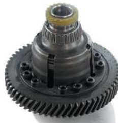
Жесткие настройки самоблокирующегося дифференциала нужны для хорошего старта. Но блокировка мешает «заправлять» автомобиль в повороты
