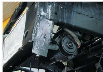
Элементы кузова можно усиливать только накладками толщиной максимум 2 мм, чтобы они не выполняли роль балласта. Зато можно переносить вперед агрегаты — например, насос усилителя руля (на фото). Радиатор системы охлаждения свободный
