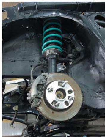
Тормоза часто оставляют серийными — ими почти не пользуются. Колесо можно расширить с помощью проставок
