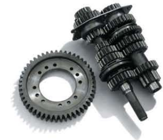
В классе N-1600 допускается установка кулачковых коробок передач в стандартном картере. Некоторые спортсмены обходятся на треке всего четырьмя передачами. Передаточное число главной передачи подбирают в зависимости от конфигурации ипподрома и состояния льда — помимо серийного можно использовать еще два варианта
