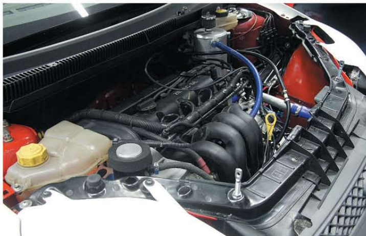
Для моторов паспортной мощностью менее 130 л.с. допустимы два варианта подготовки, так называемые зимний (по требованиям N-1600) и летний (разрешенный в Туринг-Лайте). В первом максимальная степень сжатия — 12,2:1, подъем клапанов — 11 мм. В Туринг-Лайте эти ограничения 11:1 и 9,5 мм соответственно, зато разрешены облегченные поршни, расточка каналов в головке блока и впускном коллекторе, а также дроссельная заслонка диаметром 56 мм. За счет этого «летний» мотор обычно мощнее, но не так эластичен. В обоих вариантах выпуск свободный
