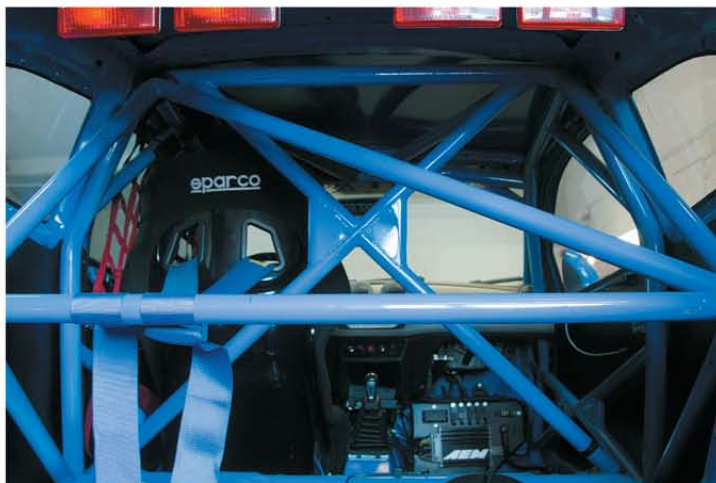
На каркасе безопасности в трекowych гонках не экономят — на ипподроме можно получить сильный удар даже в крышу. Тем более что ограничение минимальной массы в 1030 кг все равно заставляет на большинство автомобилей устанавливать балласт. Все стекла, кроме лобового и водительской двери, разрешено заменять на поликарбонатные
